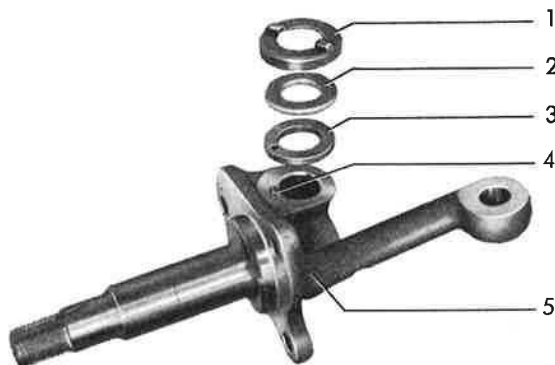
1 – Skyddsbricka 2 – Plastbricka 3 – Tryckbricka 4 – Stoppstift 5 – Styrspindel
